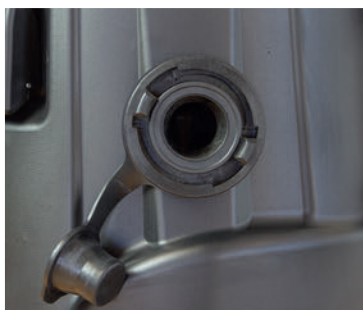
C- Rohr Anschluss für Abwasser
